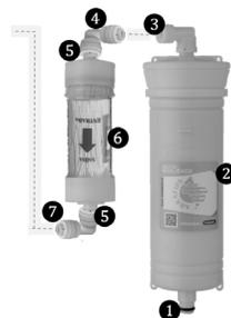
**PASSO 4:** Conecte a mangueira flexível da saída da câmara (3) à entrada do módulo (4);
